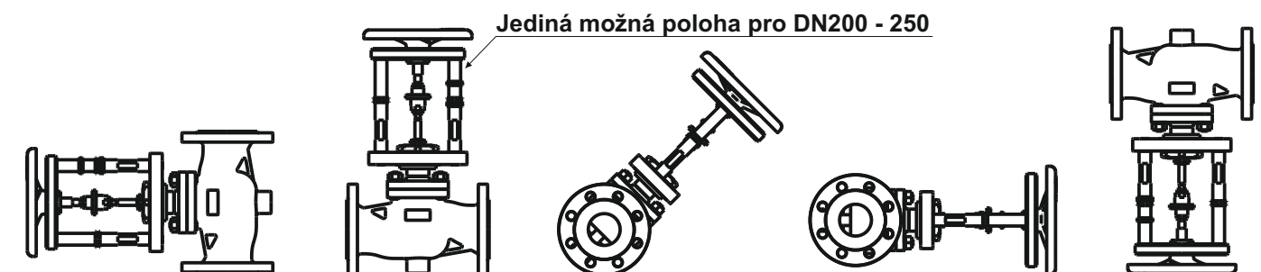
Montážní polohy ventilů s ručním kolem
