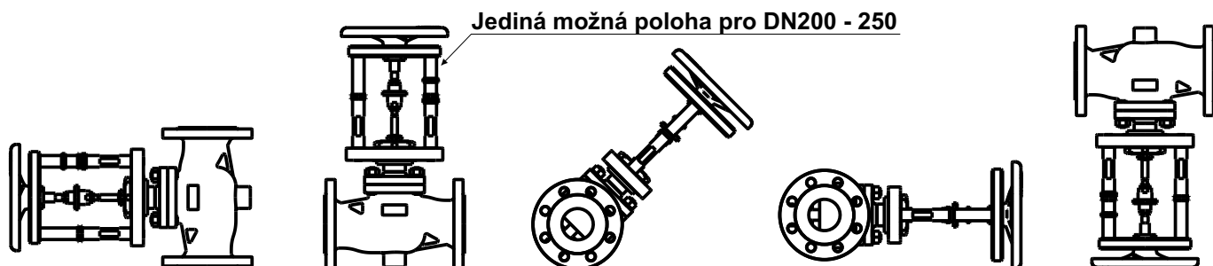
Montážní polohy ventilů s ručním kolem
